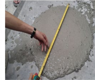
Hình 10. Kết quả kiểm tra độ chảy xòe.
