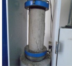
Hình 14. Nén mẫu trong phòng thí nghiệm.
