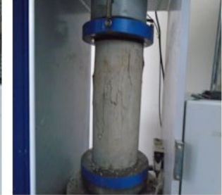
Hình 14. Nén mẫu trong phòng thí nghiệm.
