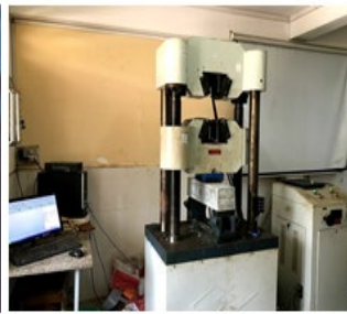
Hình 16. Máy uốn dầm của hãng Controls.
