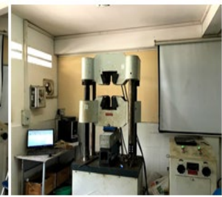
Hình 16. Máy uốn dầm của hãng Controls.
