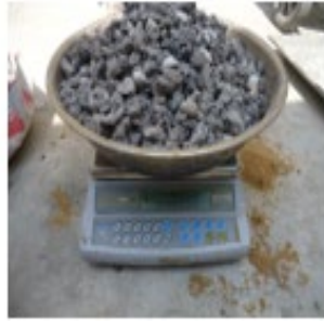
Hình 7. Xỉ thép trộn trong bê tông.
